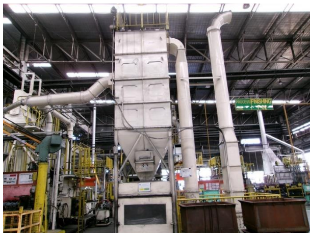
รูปที่ 2-39 Big bag เพื่อรองรับฝุ่นละอองจากการเคาะฝุ่นออกเป็นจังหวะของระบบถุงกรองของเครื่องขัดผิวชิ้นงาน และมีตัวปิดมิดชิด
