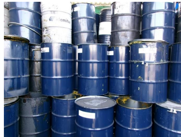
รูปที่ 2-43 ภาชนะรองรับการถ่ายน้ำมัน ที่มีฝาปิดมิดชิด และเคลื่อนย้ายไปเก็บที่โรงเก็บของเสียอันตรายพร้อมติดป้ายชี้บ่ง
