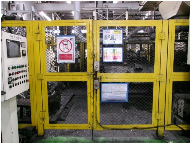
รูปที่ 2-47 การติดตั้งรั้วล้อมรอบบริเวณหุ่นยนต์แขนกลสำหรับหยิบชิ้นงาน และมีระบบ Safety plugs
