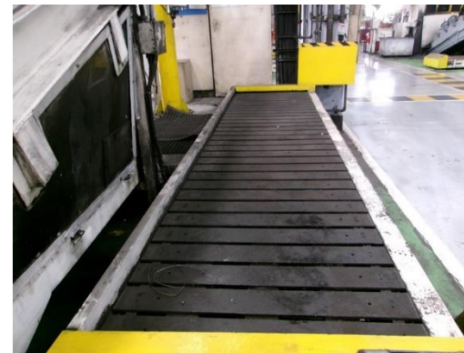
รูปที่ 2-35 ฐานรองเพื่อลดความสูงของรางลำเลียงชิ้นงานที่ออกจากขั้นตอนการผลิตลงสู่กระบะเหล็กรองรับชิ้นงาน
