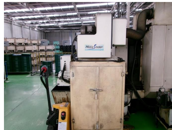
รูปที่ 2-40 ชุดกรองอากาศภายในเครื่อง CNC
