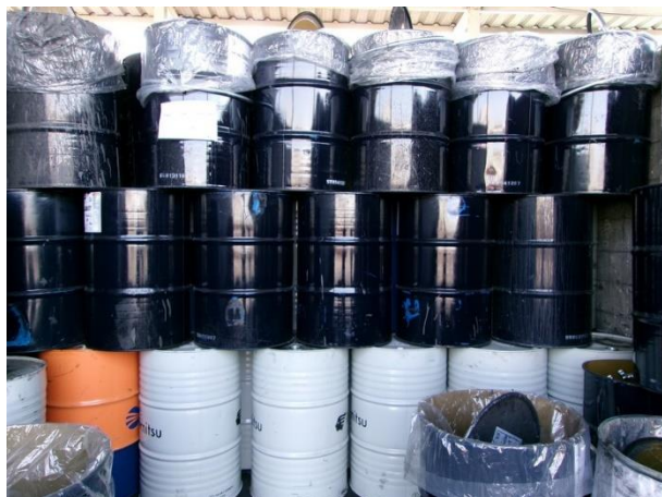
รูปที่ 2-43 ภาชนะรองรับการถ่ายน้ำมัน ที่มีฝาปิดมิดชิด และเคลื่อนย้ายไปเก็บที่โรงเก็บของเสียอันตรายพร้อมติดป้ายชี้บ่ง
