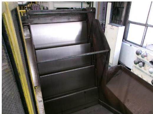
รูปที่ 2-34 ชั้นพักชิ้นงานในการลำเลียงเหล็กท่อนของสายพานลำเลียงที่ไหลเข้าสู่ห้องอบให้ความร้อน
